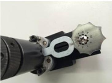
Den hinteren Teil der Ösen wie im Bild gezeigt mit der Profilscheibe in Kontakt bringen.
