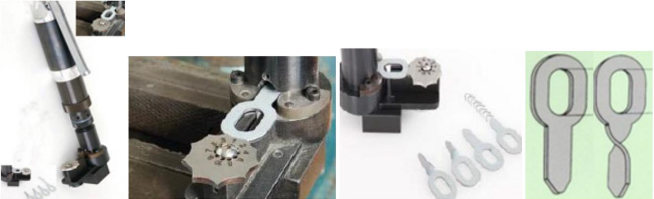
L'affilatore pneumatico di anelli permette il taglio della punta degli anelli di tiraggio per evitare la molatura complicata e fastidiosa di un anello alla volta. Ogni anello può essere affilato fino a 10 volte.
