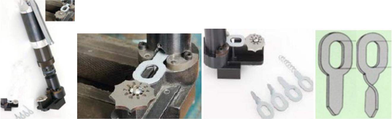
Der pneumatische Bitcutter dient zum Nachschneiden der Anschweißspitzen von Zugösen in 10 unterschiedlichen Längen. Eine gleichbleibend hohe Reparaturqualität kann nur durch Verwendung gleicher Bitlängen mit sauber nachgeschnittener Anschweißfläche gewährleistet werden.
