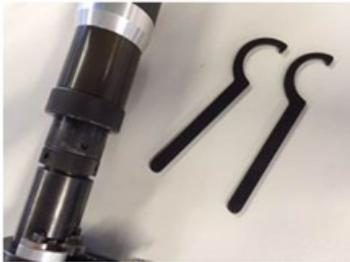
Sollten sich Ausfransungen an der Spitze befinden, kann die Hubhöhe der Matrize mittels der 2 mitgelieferten Schlüssel verändert werden. Hierzu den oberen Werkzeugteil lösen, die Hubhöhe anpassen und mittels der Hakenschlüssel verriegeln.
