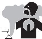
Beim Schweißen entstehen Rauchgase bzw. toxische Dämpfe, die zu Sauerstoffmangel in der Atemluft führen können. Sorgen Sie daher immer für ausreichend Frischluft, technische Belüftung (oder ein zugelassenes Atmungsgerät). Verwenden Sie die Schweißanlagen nur in gut belüfteten Hallen, im Freien oder in geschlossenen Räumen mit einer den aktuellen Sicherheitsstandards entsprechender Absaugung.
